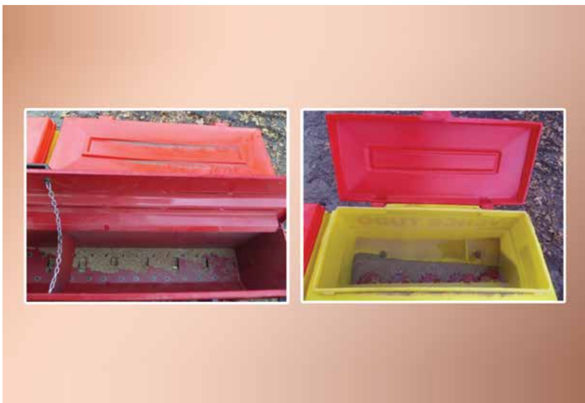
Рисунок 26. Металлический бункер для семян и пластмассовый бункер для минеральных удобрений
