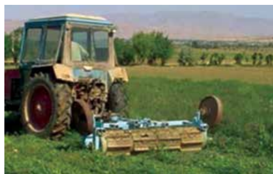
Рисунок 14. Деформирующий каток для прикатывания покровных культур
