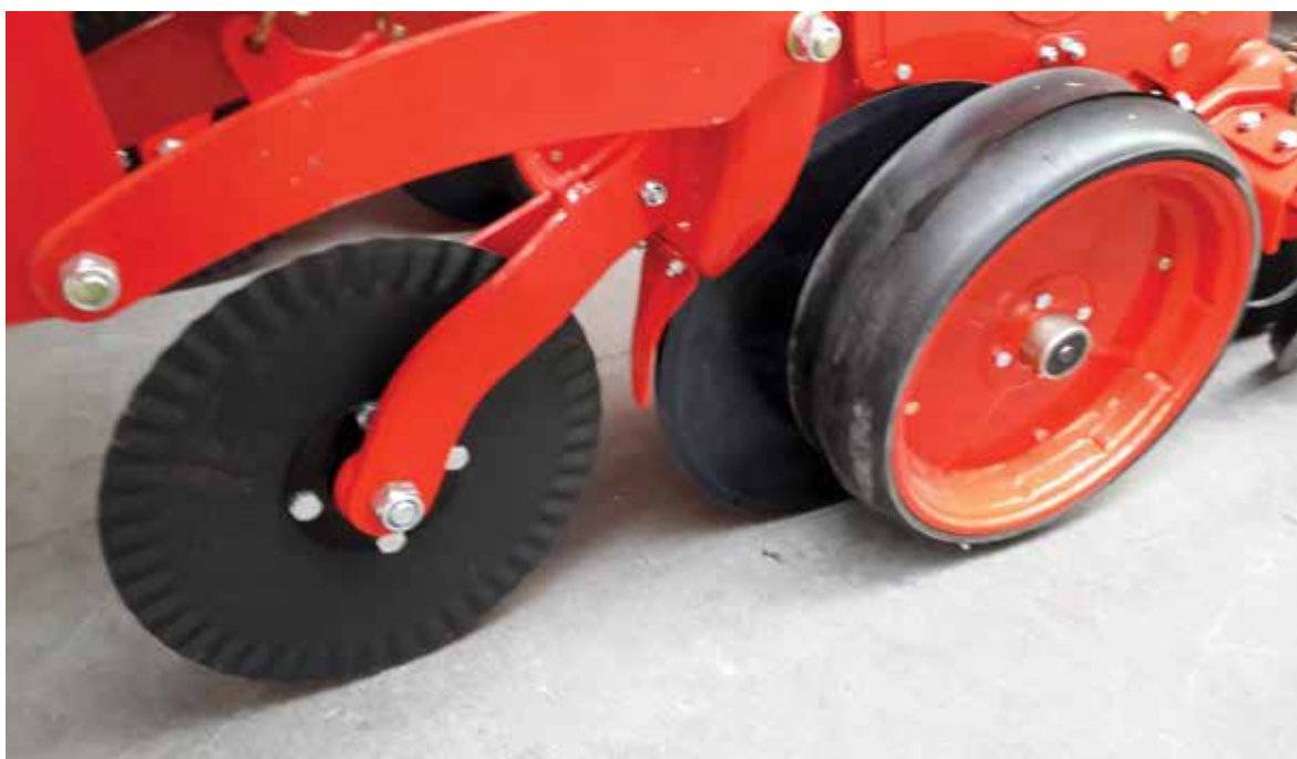
Рисунок 30. Диск (кольтер) для разрезания растительных остатков
