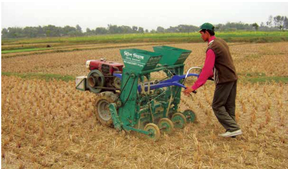
Рисунок 20. Сеялка нулевого посева на мотоблоке
