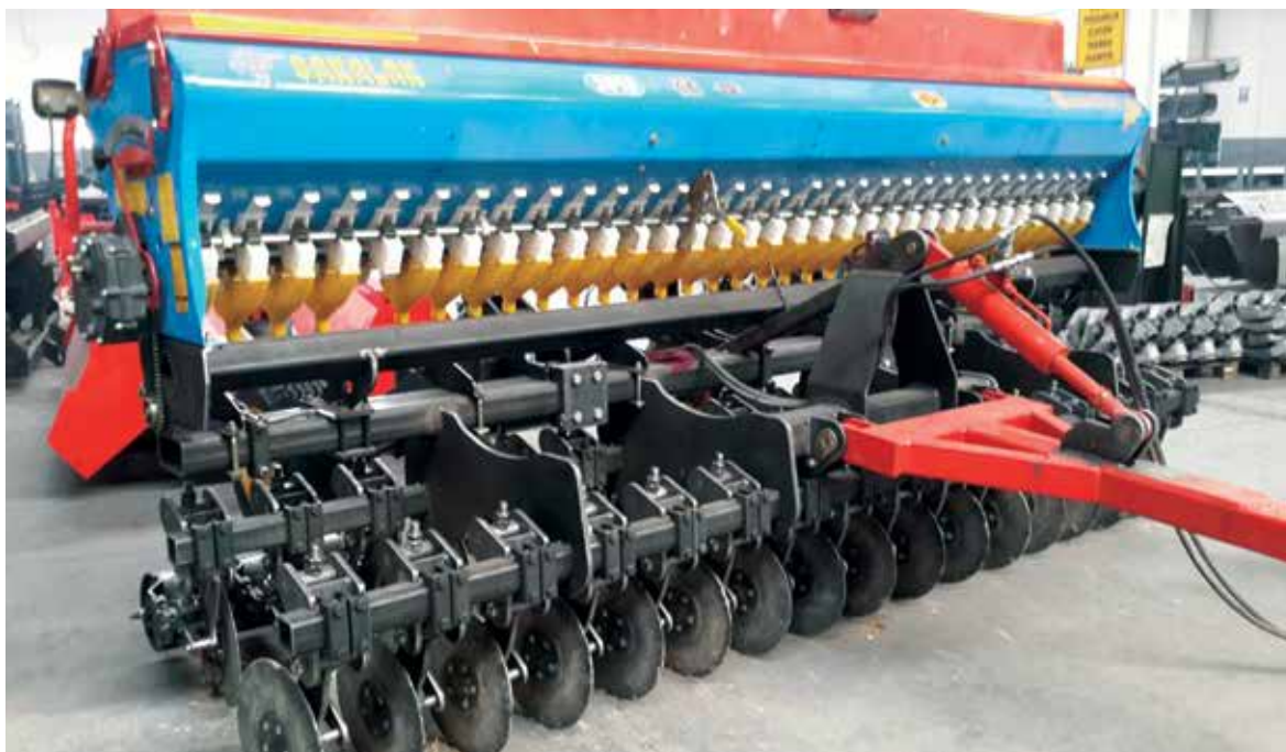
Рисунок 21. Сеялка для нулевого посева узкорядных культур
