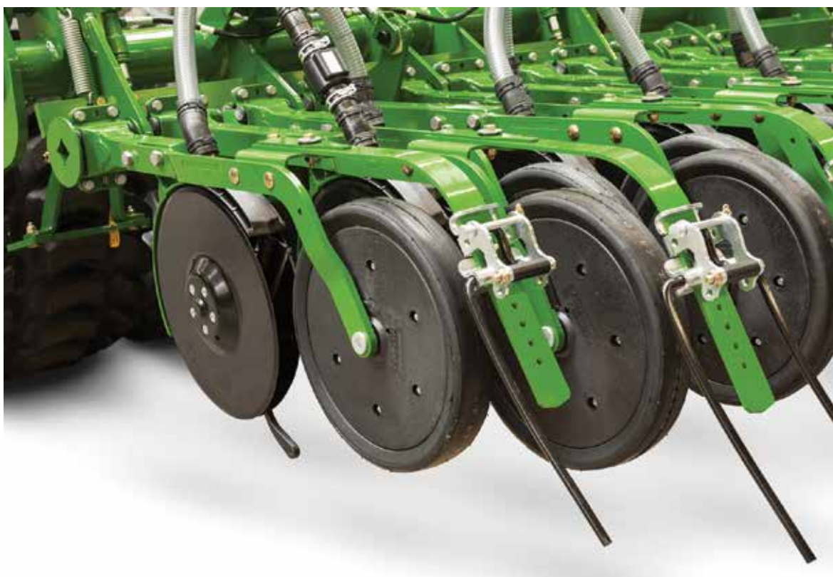
Рисунок 28. Двухдисковые сошники со смещенными дисками
