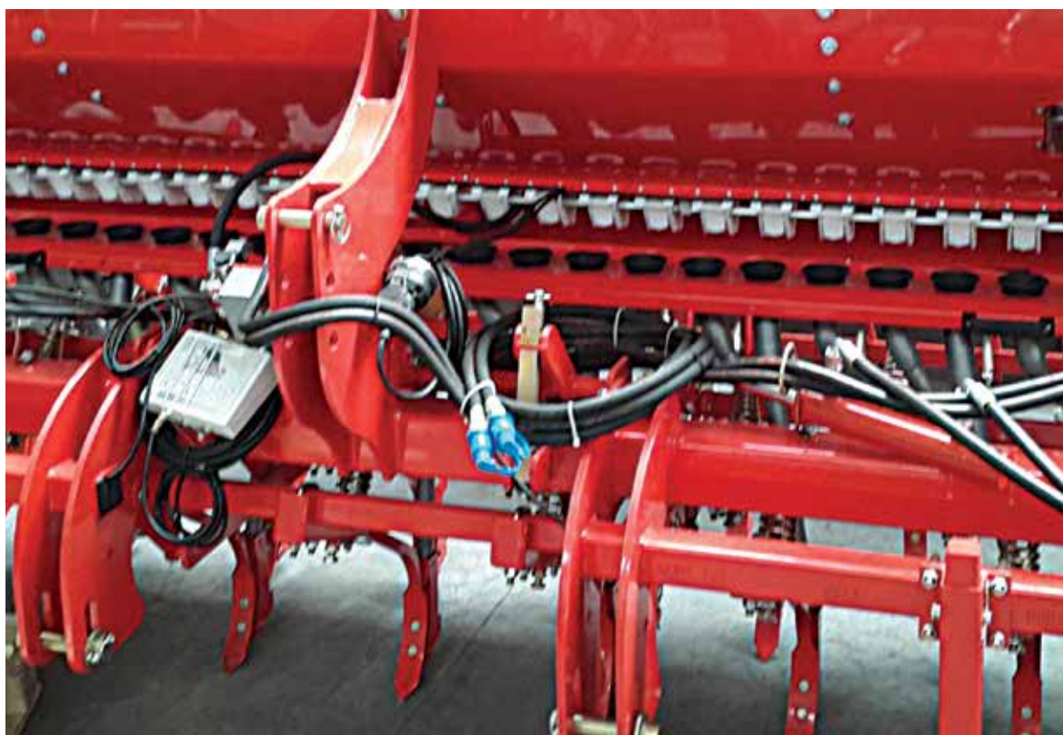
Рисунок 29. Сялка с долотовидными или анкерными сошниками
