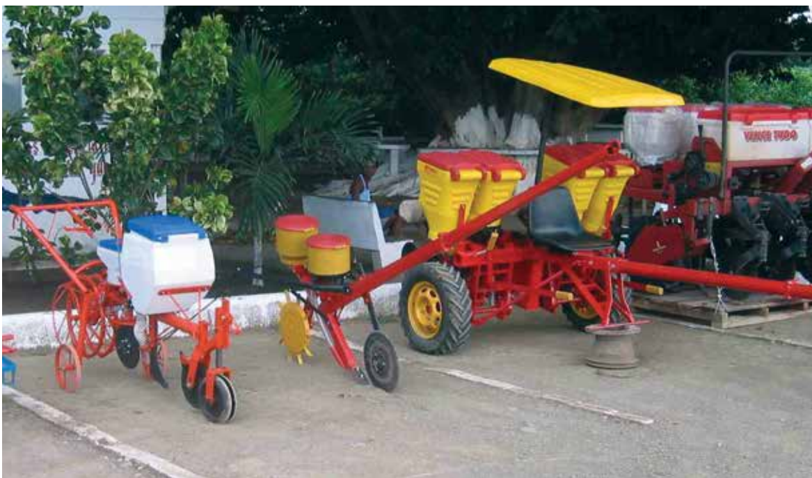
Рисунок 19. Сеялки на гужевой тяге
