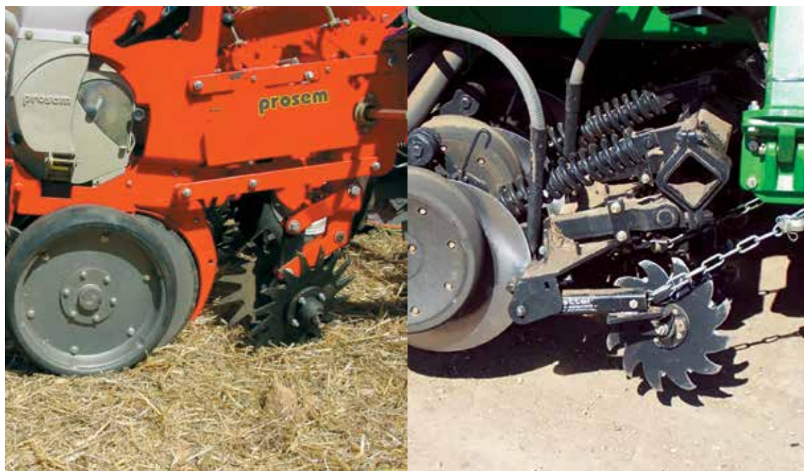
Рисунок 24. Примеры режущих дисков
