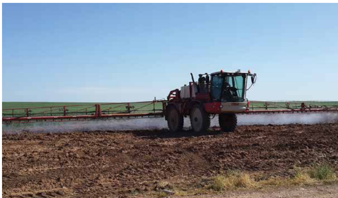
Рисунок 15. Штанговый опрыскиватель для внесения гербицида
