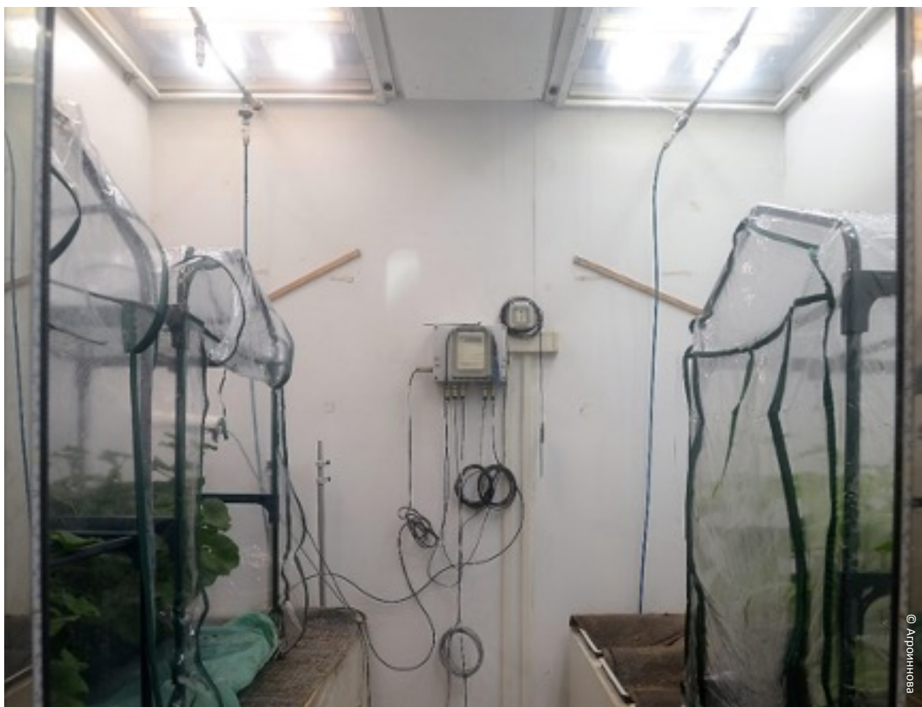
Фитотроны, используемые для вегетативного роста в контролируемых условиях. Благодаря имитационному моделированию многочисленных факторов окружающей среды фитотроны позволяют изучать воздействие изменения климата на растения и поражающие их патогены.
