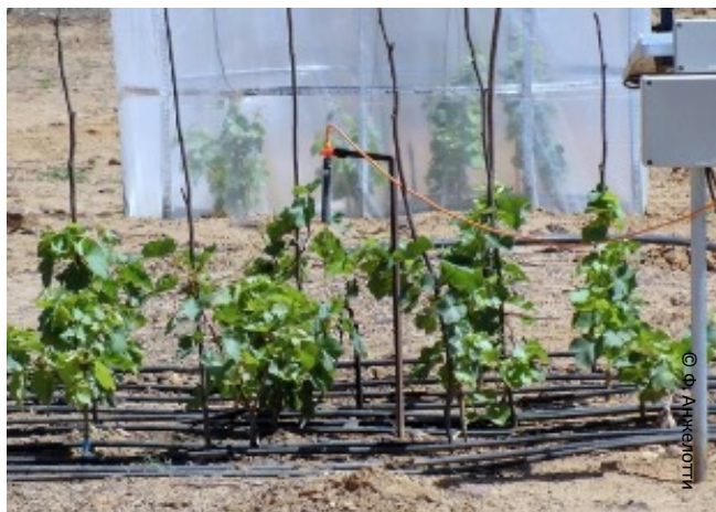
Камеры с открытым верхом для изучения воздействия увеличения концентрации CO 2 в воздухе в Петролине, Бразилия
