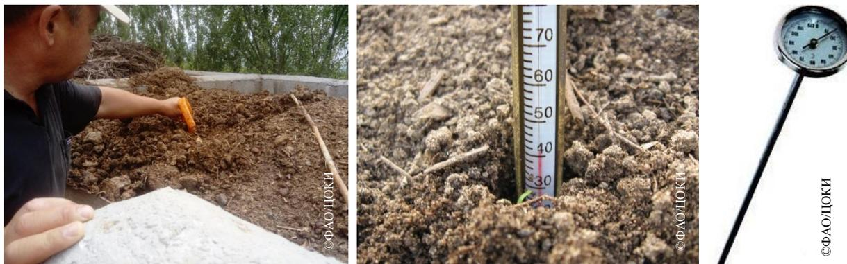
**Фото 3. Слева на право: 1. Определение температуры в компосте, 2. Температура 40°C, при норме 60~70°C, 3. Измеритель температуры**
