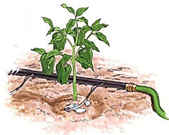
Рис. 16. Точечная подача воды на растение при применении СКО
