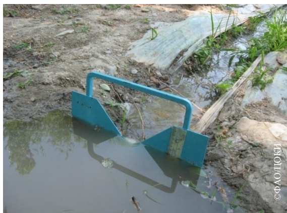
Демонстрационный участок «Метод полива по бороздам с применением водослива Томсона и Чиполетти»
