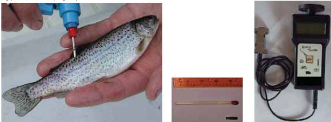
Рисунок 20_5.2 Введение РІТ метки в тело рыбы (слева); РІТметка в правом нижнем углу (в центре) и сканер (справа).
