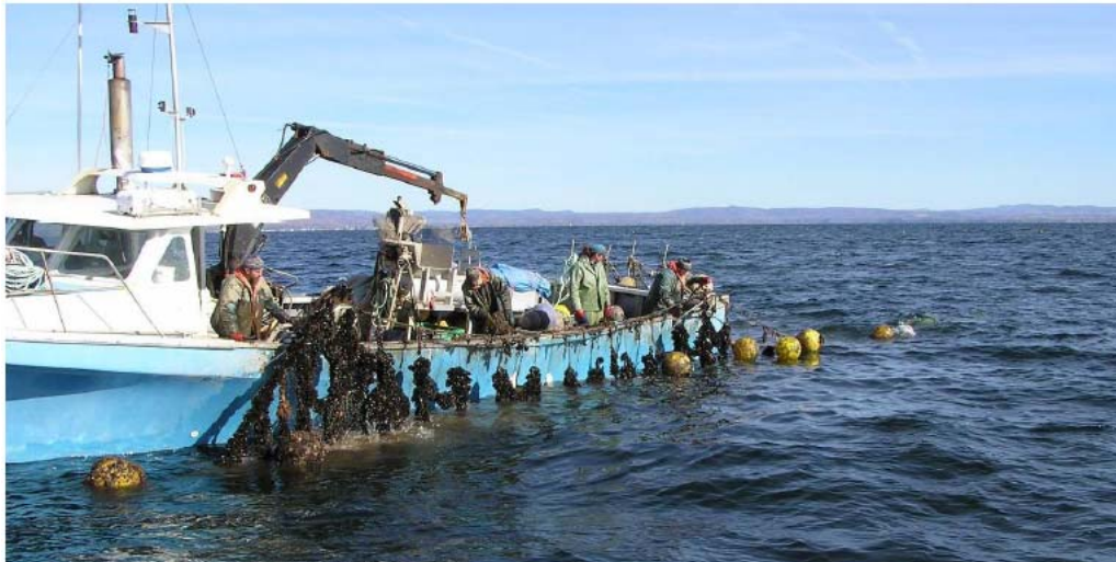
Рисунок 9.13 Подъем яруса с помощью лебедки
