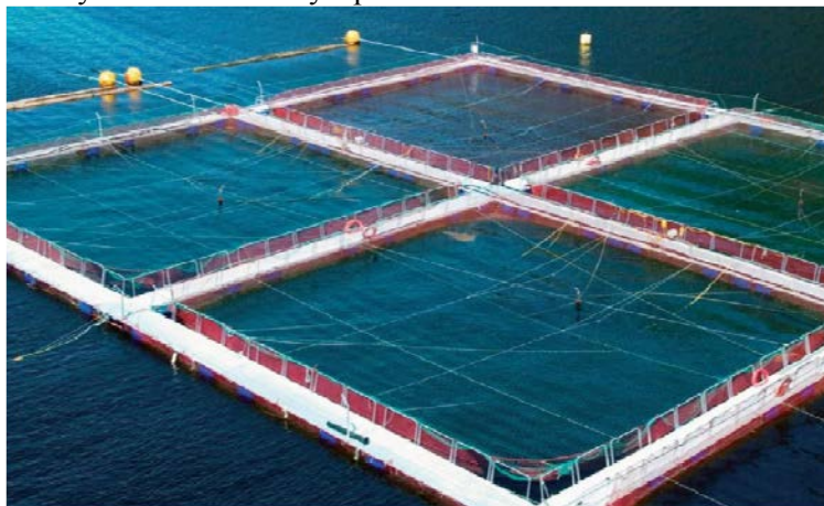
Рисунок 10.3 Wavemaster, вероятно, является самой продаваемой жесткой садковой системой. Изображение предоставлено AKVA group.
