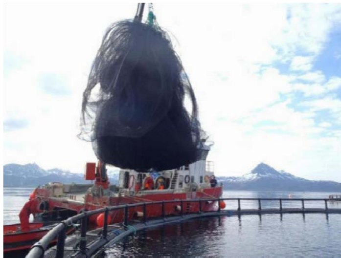
Рисунок 10.13 20 тонная катамаранная лодка часто используется для проведения ежедневных процедур на норвежских лососевых садковых фермах. Краны предназначены для подъема мешков и сетей с кормом. Кроме того, на таких лодках может быть установлена система кормления. Изображение
