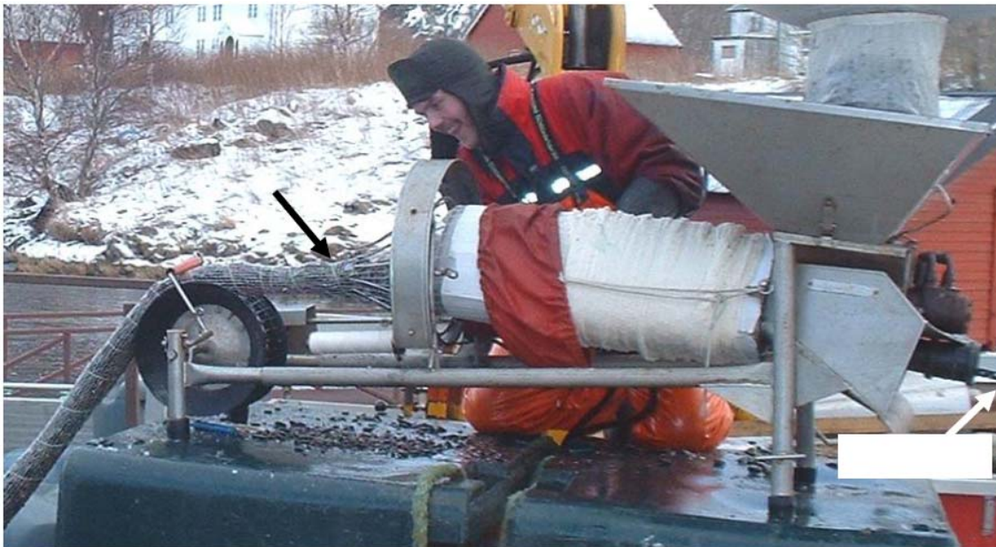
Рисунок 9.54 Испанское посадочное устройство: отделенные и отсортированные мидии попадают в бункер и управляются буром, попадая в хлопковую посадку с тросом.
