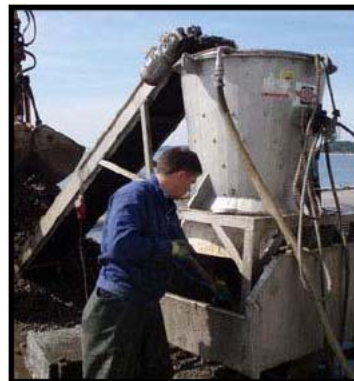
Рисунок 9.39 Вращающийся конический крамплер отделяет мидии от троса и пластиковой сетки
