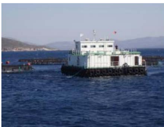
Рисунок 10.12 Кормовые баржи становятся все более популярными в садковых хозяйствах. Баржи AKVA Group могут вмещать от 100 до 700 тонн корма (сверху слева). Слева снизу изображены кормовые баржи в Турции, справа – в Норвегии. Изображения AKVA group.
