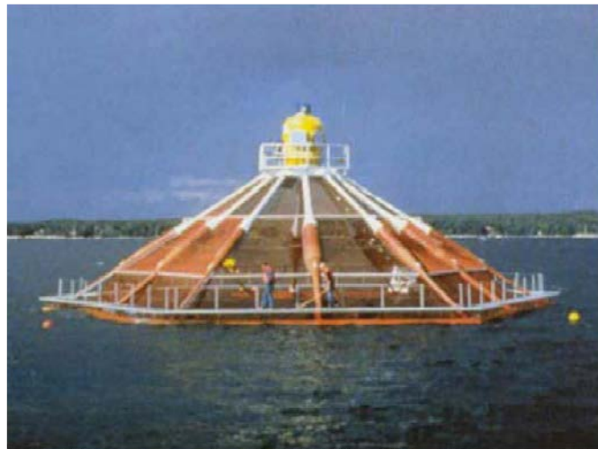
Рисунок 10.5 Первая полупогруженная океанская ферма была построена в Швеции в 1986 году. После этого, по всему миру стали использовать, как минимум, 40 таких единиц. Изображение Farnoscan.
