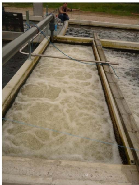
Рисунок 20_4.5 Работа эрлифта в действующих рыбоводных хозяйствах
