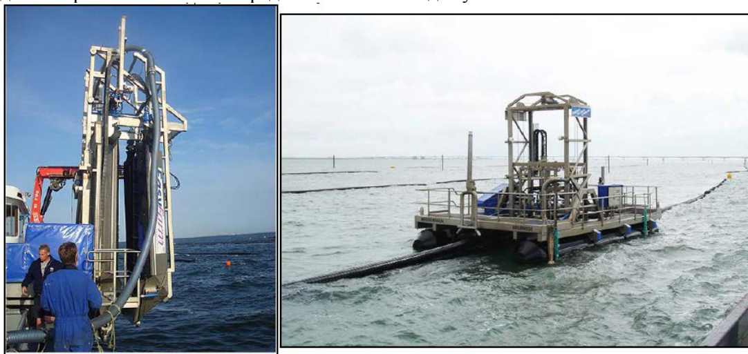
Рисунок 9.24 Мобильные системы по уборке мидий. Фото приведено из брошюры EasyFarm
