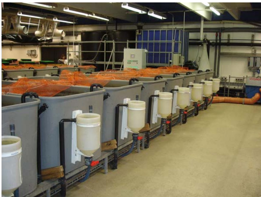
Рисунок 20_6.42 Научная УЗВ для исследований в области кормления рыб компании Biomar, Хиртсшальс, Дания
