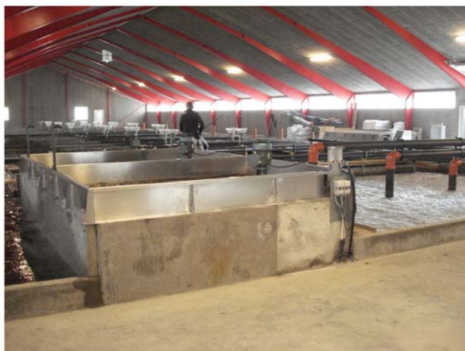
Рисунок 20_1.3 Блок выращивания с блоком аэрации и инжекционной платформой на переднем плане
