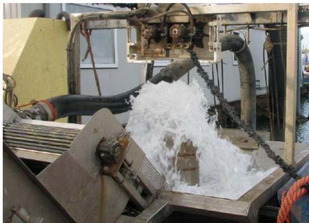
Рисунок 9.44 Конвейер с устройством расслоения и сортировки
