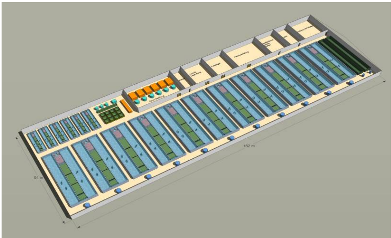
Рисунок 20_6.15 Схема УЗВ с бетонными прямоугольными бассейнами (вариант 2)
