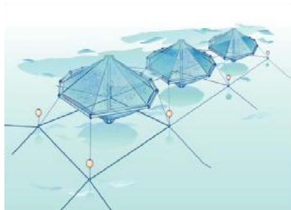
Рисунок 10.6 Ферма SeaStation компании Ocean Spar не имеет плавающего кольца, однако основывается на тросах, которые подключены к швартовочной системе. Более 25 таких систем используются в Пуэрто-Рико и Гавайи. Фотографии Ocean Spar.
