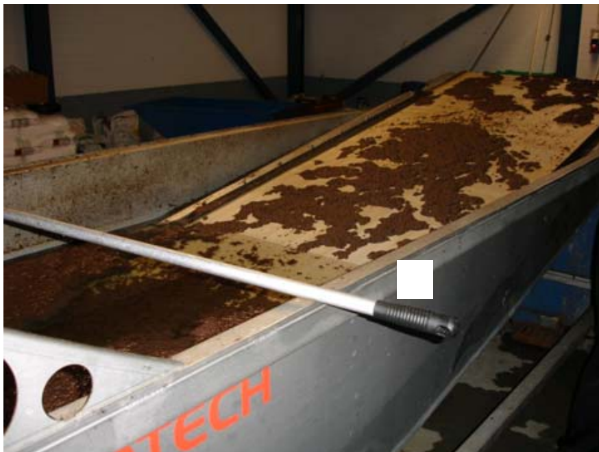
Рисунок 20_4.29 Сепаратор для сточных вод из УЗВ
