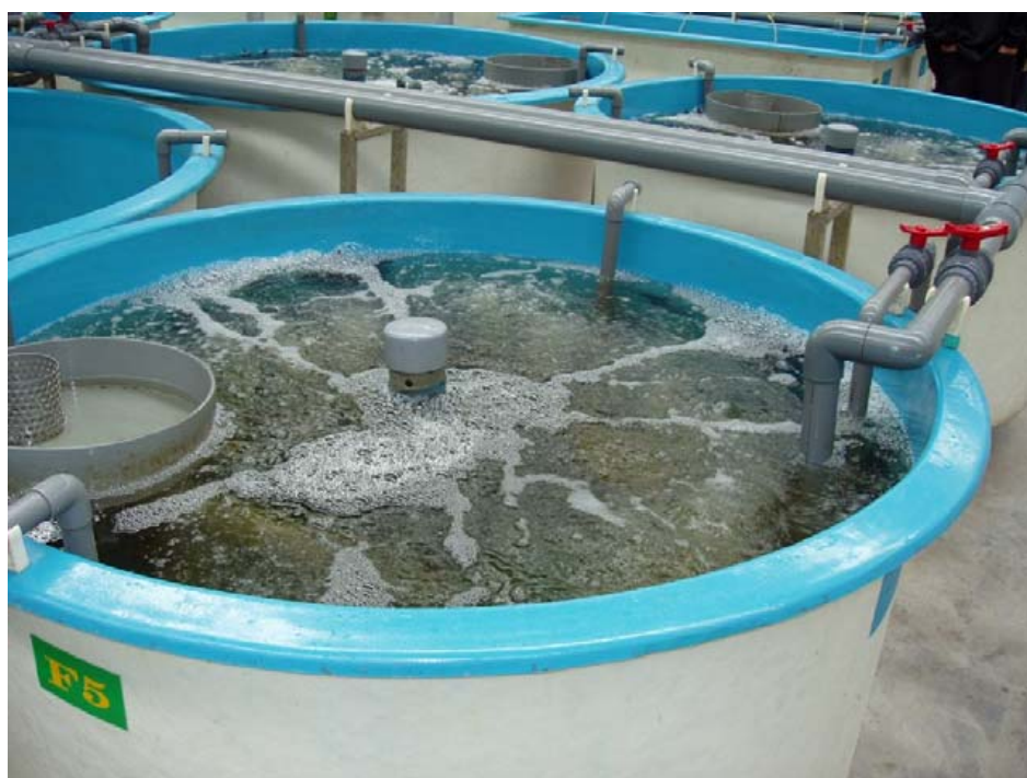
Рисунок 20_4.9 Максимальная аэрация воды в некоторых УЗВ Китая
