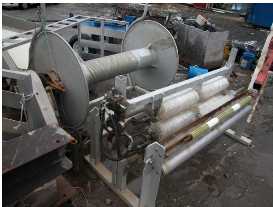
Рисунок 9.50 Простой щеточный отделитель. Фото: Jacques Dufresne, Квебек (с разрешения)
