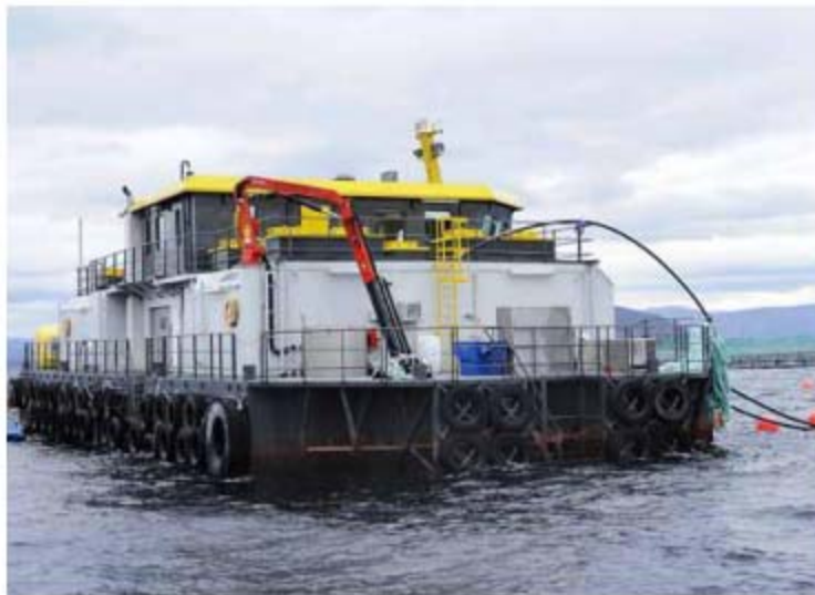
Рисунок 12.3 Современная баржа, оборудованная бункером для кормов, системой кормления, центром мониторинга, предусмотрены условия для проживания рабочего персонала и силовые установки
