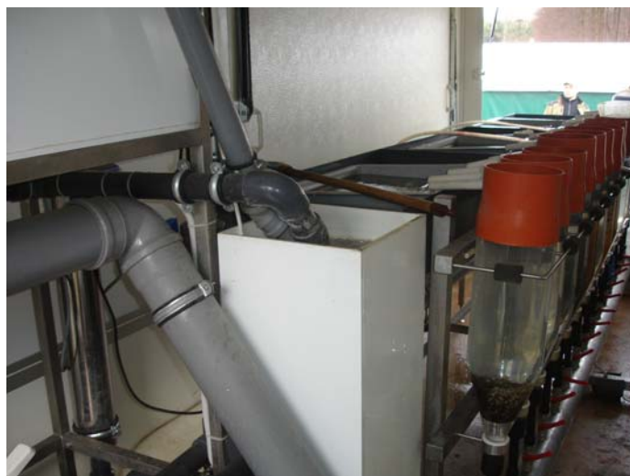
Рисунок 20_6.41 Передвижной инкубационный мини-модуль на базе автомобильного прицепа (вид внутри). Институт рыбного хозяйства, Ольштын, Польша
