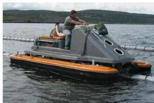
Рисунок 9.22 Механизированная уборочная машина для прореживания колонии мидий. Фото приведено из брошюры Smart Farm
