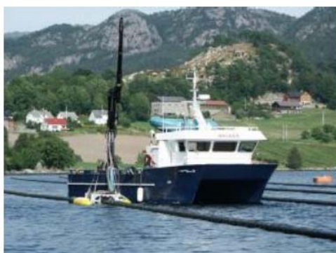
Рисунок 9.21 Судно опускает уборочную систему. Фото приведено из брошюры Smart Farm
