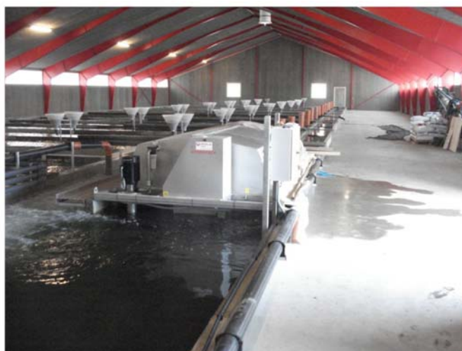
Рисунок 20_1.10 Барабанный механический микрофильтр Hydrotech с ячейей сетки 40 микрон
