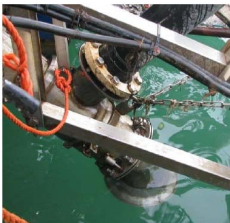
Рисунок 9.43 Отделение мидий от троса в трубе Вентури
