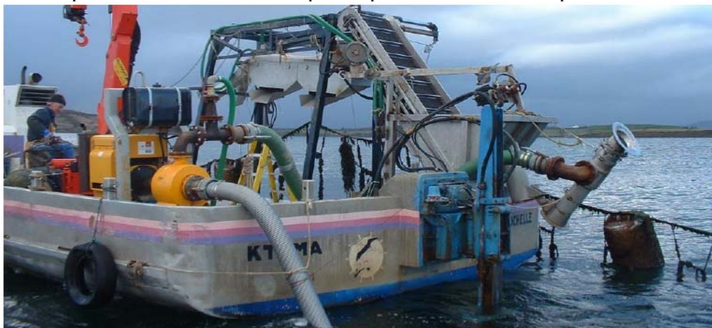
Рисунок 9.40 Судно с системой насоса Venturi, которая очень эффективна для всех размеров мидий, от личинок до уборки зрелого урожая, и установлена в Ирландии, Квебеке, Голландии, Норвегии и многих других странах.
