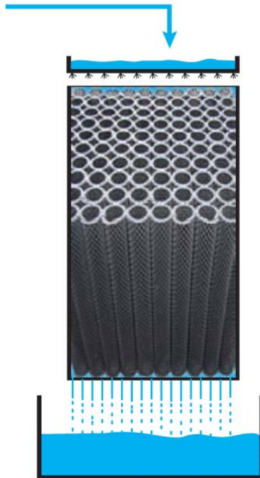
Рисунок 20_4.7 Схема работы дегазатора
