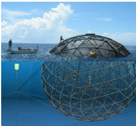
Рисунок 10.9 Ocean Farm Technology – производитель систем Aquarod. Она состоит из жесткой рамы и садка в виде шара внутри рамы. Данная технология используется в экстремальных частях прибрежной зоны, например ферма кобии в Пуэрто Рико и Панаме, а также ферма по выращиванию желтохвоста в Гавайи. Фотографии Ocean Farm Technology.
