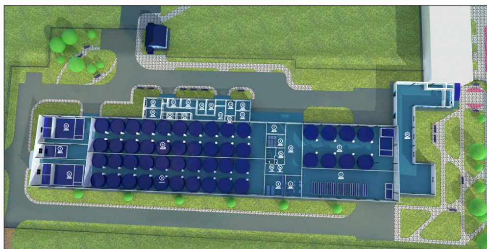
Рисунок 20_6.6 В состав рыбоводного промышленного комплекса УО БГСХА входит четыре модуля: модуль инкубации, модуль выращивания молоди до 5 грамм, два модуля выращивания молоди до 50 грамм
