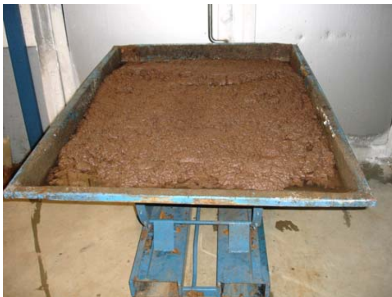
Рисунок 20_4.30 Условно твердая фракция из сточных вод УЗВ
