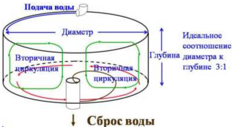
Рис. 3.2. Циркуляция воды в круглых бассейнах (соотношение сторон – 3:1)
