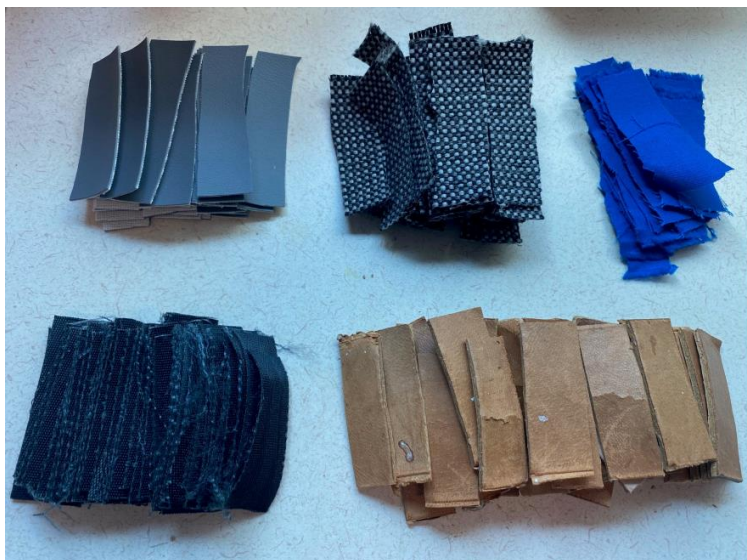
Рисунок 25. – Тест 5: Испытательные образцы из синтетической кожи (вверху слева), полиолефина (вверху посередине), хлопка (вверху справа), нейлона (внизу слева) и кожаной обложки книги (внизу справа) [262]
