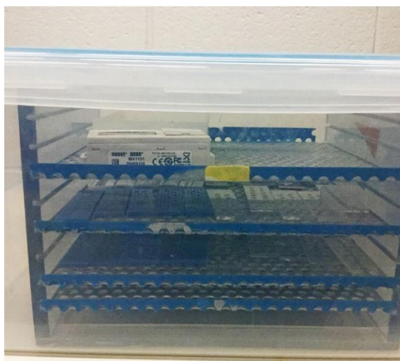
Рисунок 17. – Сушка образцов теста 3 после инокуляции в шкафу биобезопасности класса II (BSCII) [260]
