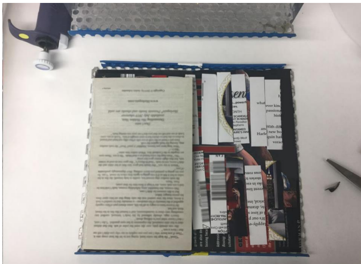
Рисунок 21. – После инокуляции тестовые образцы были размещены внутри камеры экспонирования и уложены на аналогичный материал (штабелирование) [261]
