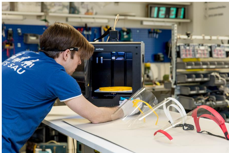
Рисунок 110. – Изготовление составных частей защитных масок для медицинских работников с помощью 3D-принтера в Национальной библиотеке Литвы [138]
