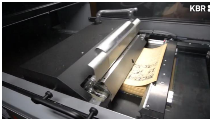
Рисунок 54. – Оцифровка книги сканером-роботом [274]
