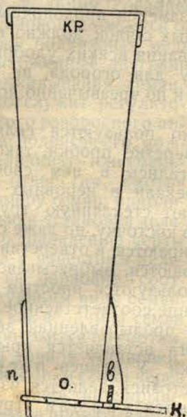
Посевной рожок с крышкой кр. и с кружком к ; в — винт, держащий кружок; п — пружина; о — отверстие кружка.
