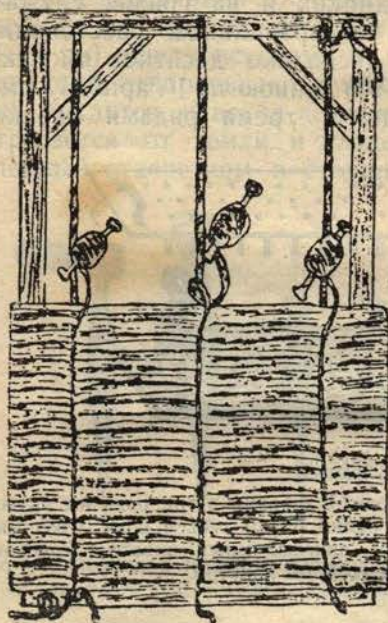
Рис. 93. Рама для плетения соломенных матов. Катушки с шпагатом приподняты для наглядности.
