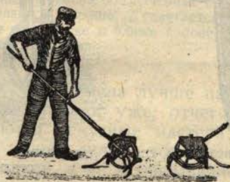
Рис. 84. Ячейстые простые и двойные посевные кружки Р. Сакка: 1 градация—h, 2—a; 3—b, 4—c, 5—f, 6—g, 7—d, 8—i, для гнездового посева свеклы—e. Кружки (ниже), a—для гнездового посева свеклы, b—для мелких семян, c—ржи, d—гороха и овса, e—бобов, кукурузы. Направо—однорядная ручная рядовая сеялка Сакка.
