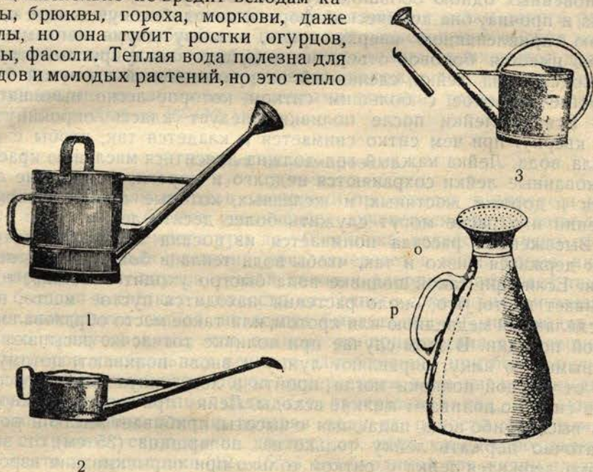
Рис. 103. Лейки. 1) Лейка с двумя ручками, двумя обручами, придонным кольцом с носиком на двух скрепах и с ситком. 2) Тепличная лейка. Ситко поворачивается в разных плоскостях. 3) Новая немецкая лейка с одною ручкою. 4) Компактная лейка М. В. Рытова. Снаружи под ситком и между лапками рукоятки p имеется отверстие o , ведущее во внутреннюю плоскую трубку, очерченную на рисунке пунктиром.
