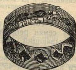
Рис. 78. Рядовая барабанная сеялка Планета \frac{1}{15} натур. вел. и подвижной регулятор на барабане сеялки Планета \frac{1}{5} натур. величины.
