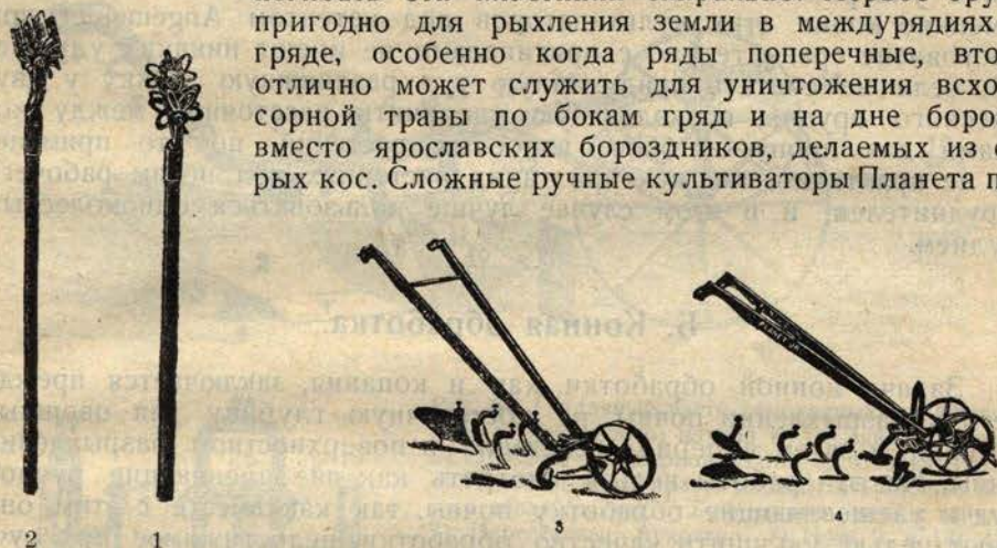
Рис. 52. Ручные культиваторы. 1) Простой скобчатый культиватор. 2) Простой пластинчатый культиватор. 3) Сложный одноколенный культиватор „Планета“ старой конструкции. 4) Двухколенный культиватор „Планета“ старой конструкции.
