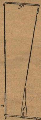
Рис. 8. Посевной ро- жо. Рытова с крышкою кр. и с кружком к; в— винт, держащий кру- жок, н—пруж., о—от- верстие кружка.
