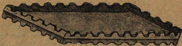
Рис. 2. Полотняная рама для досушивания вне сушилки. Отличается от шкафной рамы зубчатыми краями для проветривания.
