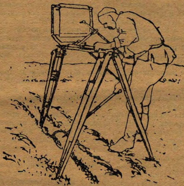
Рис. 1. Почвенный профилограф с закрепленным полюсом пантографа конструкции инженера В. П. Останьова
