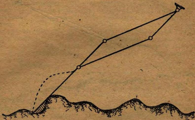
Рис. 5. Пример недоступных зон профиля для прямолинейного профилоприемника.
