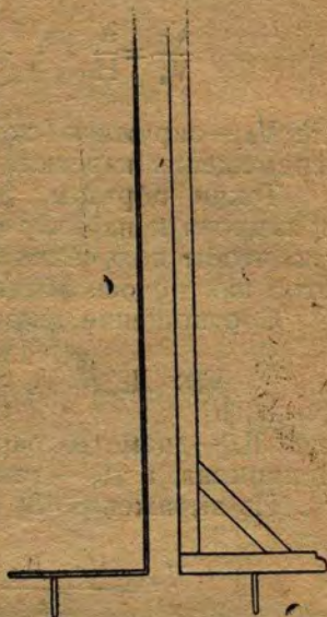
Рис. 7. Левая стойка профилографа, допускающая перемещение пантографа.
